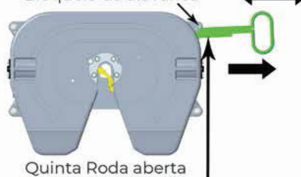
Puxar a alavanca para fora e travar o rebaixo da alavanca no prato da Quinta Roda
